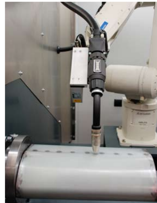
Der Mitsubishi Electric MELFA RV-12SL Roboter beginnt die Messfahrt.
