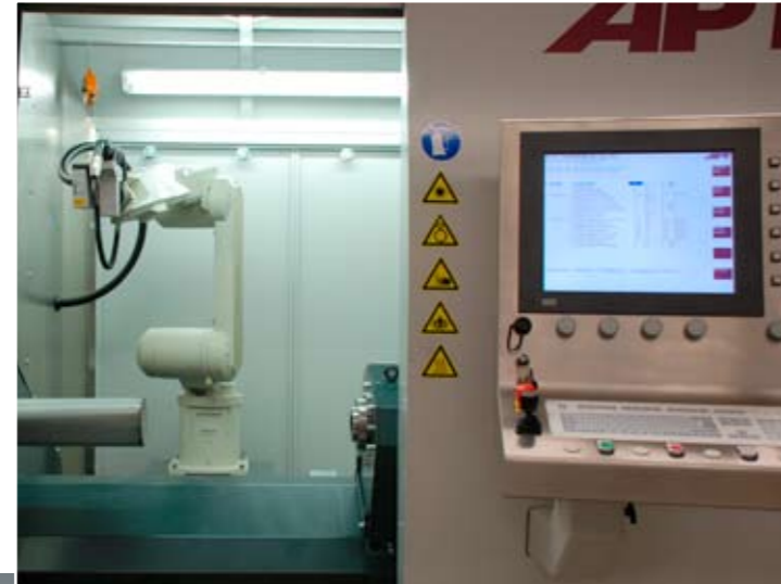
GeniaWeld Sensorgeführte Roboterschweiß-Anlage für nicht-rotations-symmetrische Werkstücke und Gegenstände.
